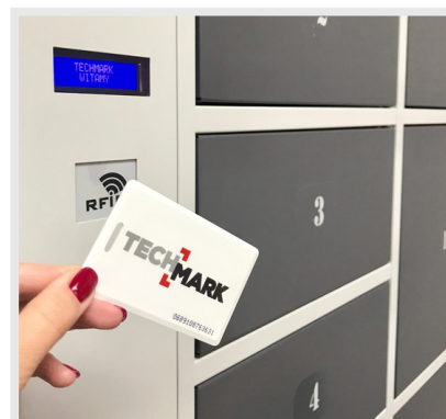
Otwieranie Szaf Techcode RFID za pomocą karty RFID
